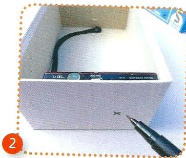
2 Damit die Kamera was sehen kann, mache nun von außen eine Markierung genau dort, wo sich das Auge der Kamera, das Objektiv, befindet. Bohre und schneide ein Loch hinein und prüfe es mit der Kamera. Schneide das Loch auch in den Deckel.
